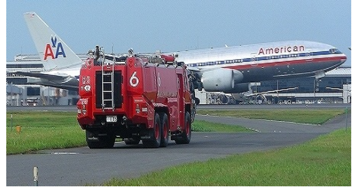
前進待機する大型化学消防車
