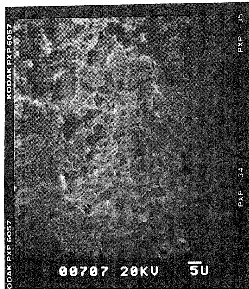
写真3 ろう付け部の破断面の拡大(1000倍)
