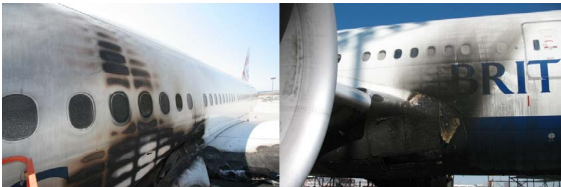
【機体の焼損の状態。左からの風で右側胴体にも火炎が及び、多くの窓が熱でひび割れ状態】
