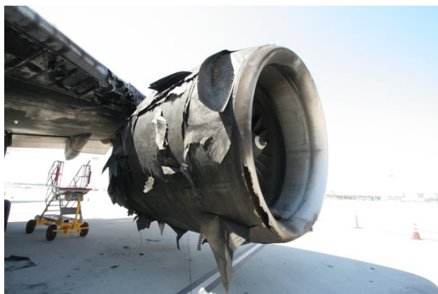
【左エンジンの右側面と主翼の焼損状態】
