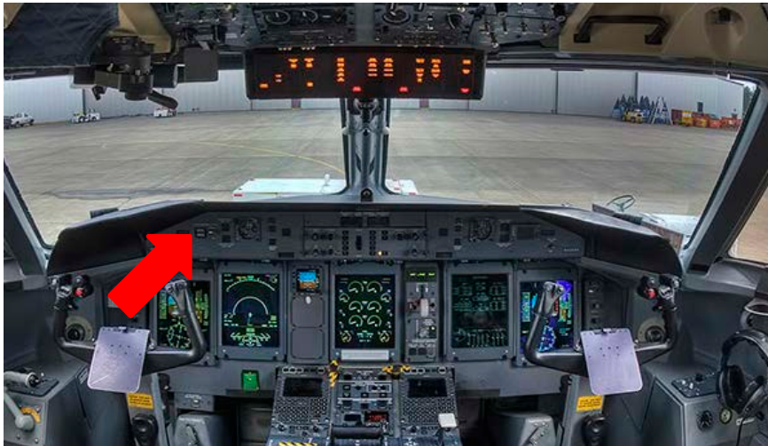
DHC8-Q400 の操縦席と DISC Light の位置 (赤い矢印)
