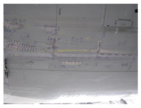
胴体後部貨物室下の構造部材の損傷状況です。(写真上が後方です) 赤テープで部材の位置を表示した箇所に変形損傷があります。
