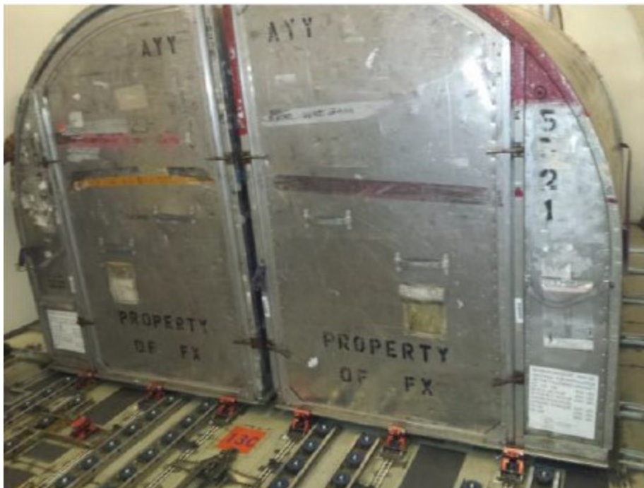
専用貨物コンテナをロック金具で固定した状態 (FedEx 提供)
