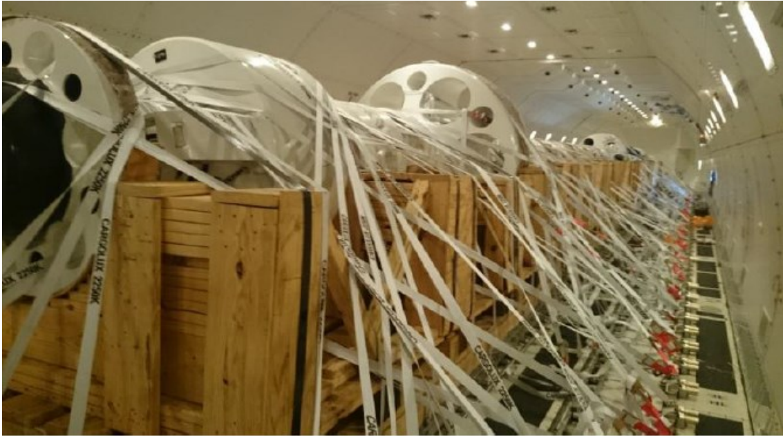
長大貨物搭載の実例 (Telair 提供)
