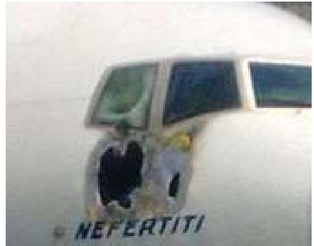
2011年7月29日、エジプト・カイロ空港で乗員乗客 307 名が乗ったカイロ発ジェッダ行きのエジプト航空 B777-200 型機が、全ての準備を整え Push Back 指示を待っていた際に、操縦室右席後方から濃い煙と共に発火が起きたが、幸運にも空港の消防機関によって鎮火出来た。現時点で火災の原因は、パイロットが持っていたノートパソコンの充電不良で発火し、隣接した酸素マスクシステムを巻き込んで大きく燃え上がったと考察されている。写真から分かる通り、機体だけでなく操縦室のガラスをも溶かすほどの高熱が発生し、機体には相当なダメージを与える結果になった。ノートパソコンが発火を起こす事例はまれに報告されるが、この様に機体構造までに影響を及ぼす規模の発火は初めてのケースである。
