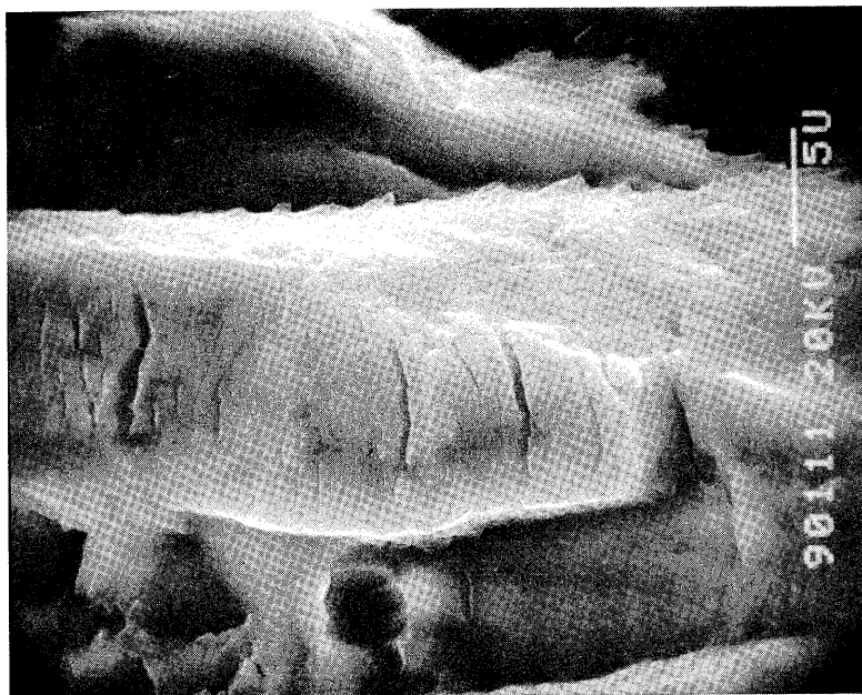
写真-114 リベット孔90番内舷(孔縁より2.60mm位置) 疲労亀裂の進展方向は、左から右である。
