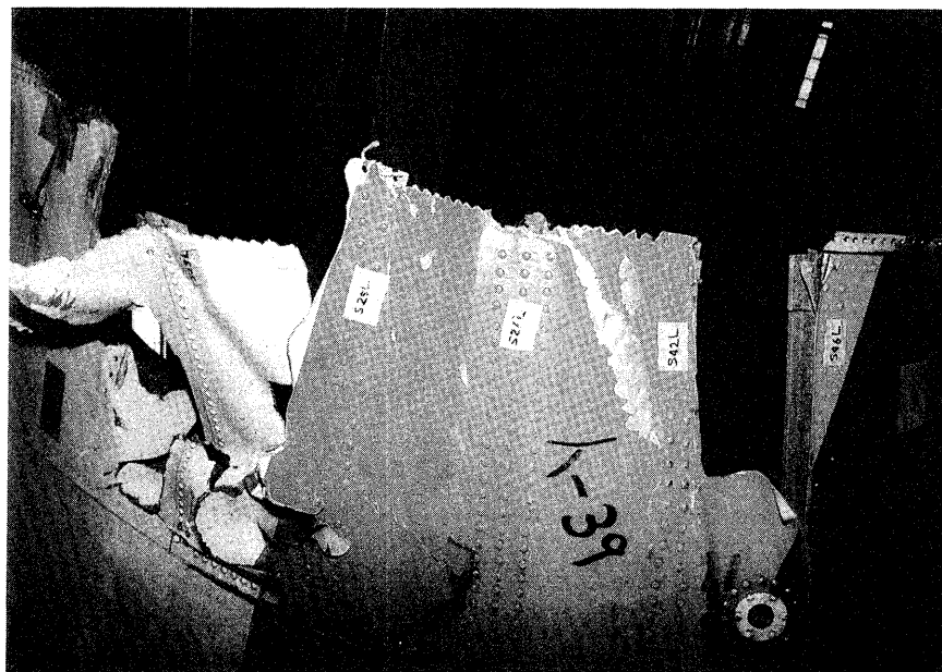
写真一 41 BS2658APU防火壁取付部 26L付近の破断状況
