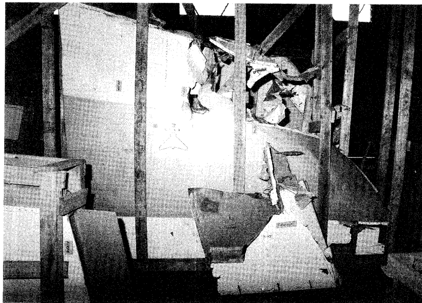
写真- 62 右側水平尾翼翼々端部の損壊状況
