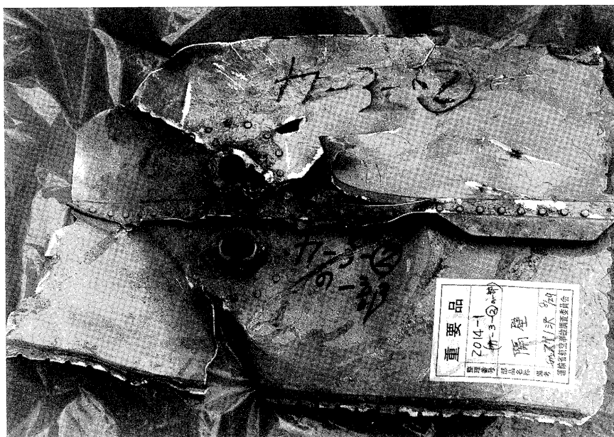
写真- 68 後部圧力隔壁パート2A(与圧側)
