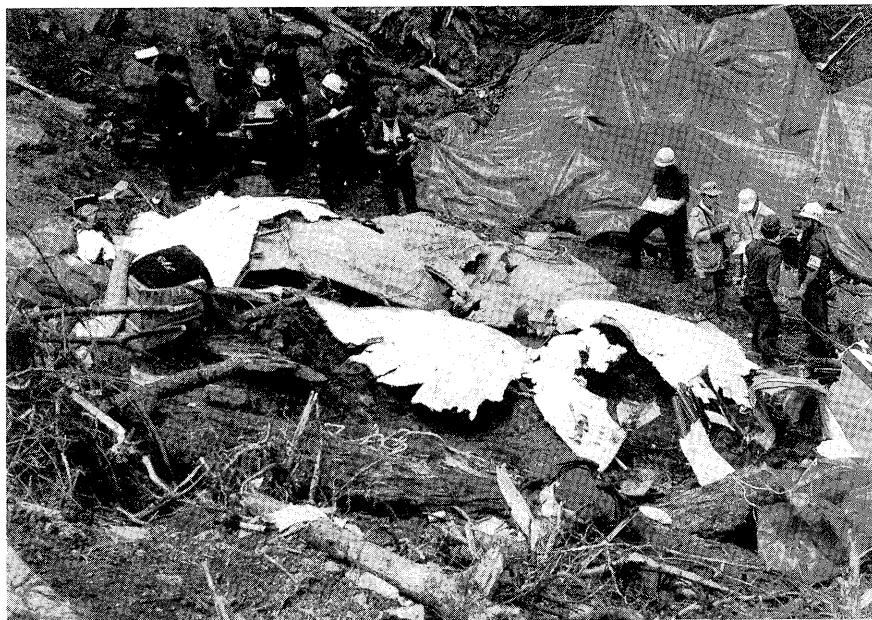
写真- 12 回収された圧力隔壁(1) 後方(非与圧)側
