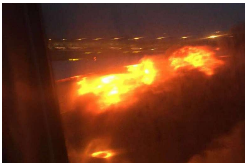
【写真 1：右エンジンおよびその周辺の火災状況】
