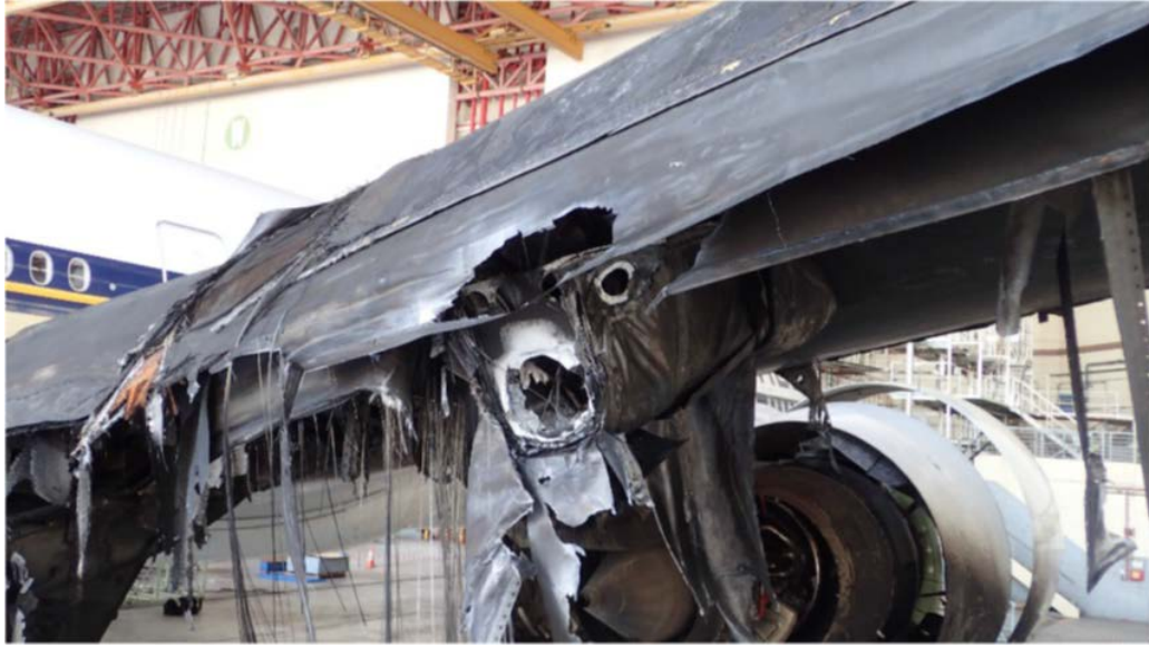
【写真 2：右翼焼損の状態】
