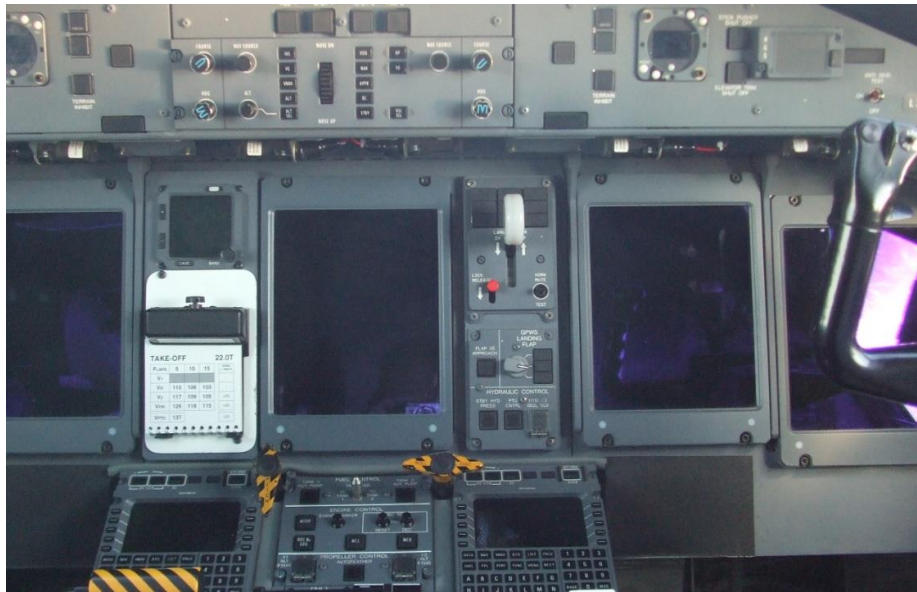
[写真中央の先端が白い部分が車輪レバー（現在上げ位置） その左下の赤いボタンが Lock Release Button]
