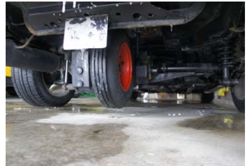
車体下部の測定用車輪
